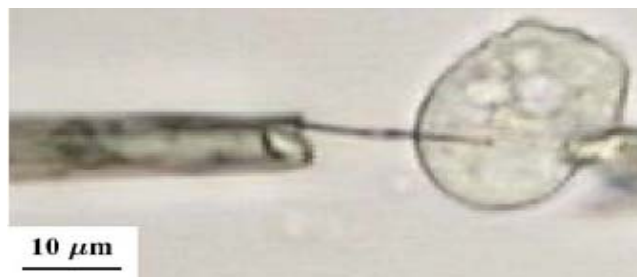
Рис. 43. Введение наносприца в клетку (в качестве иглы – многостенная углеродная нанотрубка).
