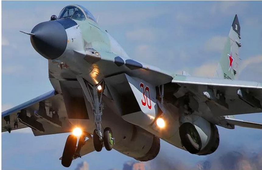
Фото.3. МиГ-29 на взлёте с полным отклонением вниз передней и задней механизации крыла.
