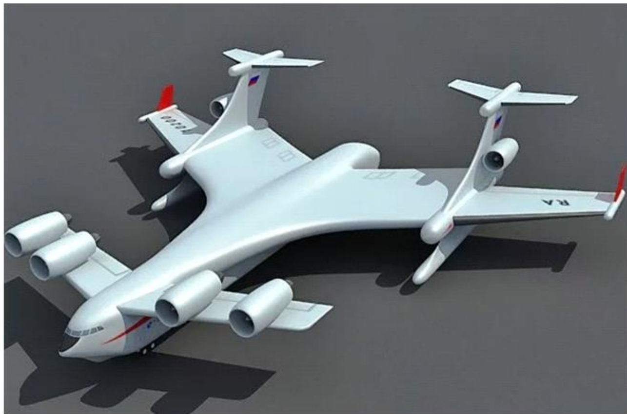
Рис.9 Экраноплан Бартини ВВА-14. а.Чертёж. б. Модель в 3-Д. в. Фото действующего образца на воде.
