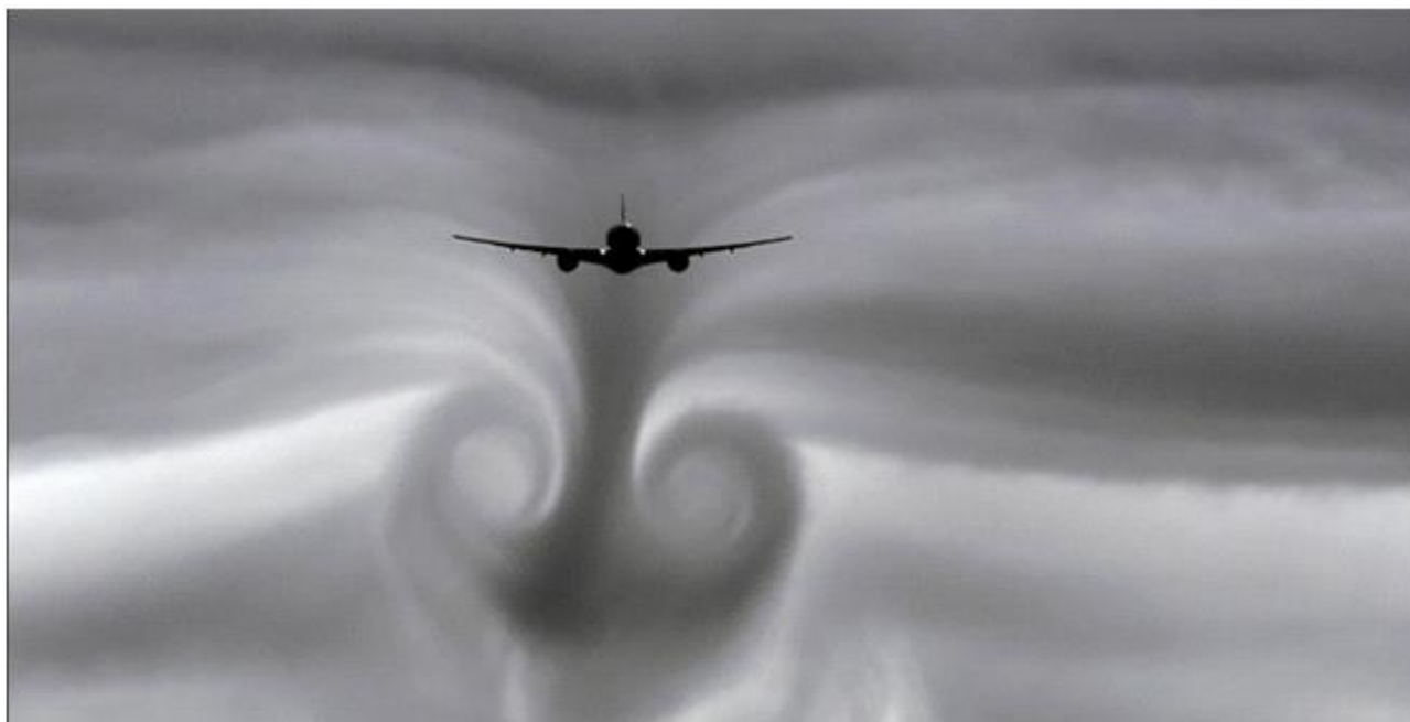
Фото.4. Вихревой след в слое тумана за летящим на высоте самолётом. Кольца видимого туманного вихря отстоят от самолёта на сотни метров, а визуальная близость – это оптическая иллюзия, созданная длиннофокусным телеобъективом при съёмке самолёта с дистанции в несколько километров.
