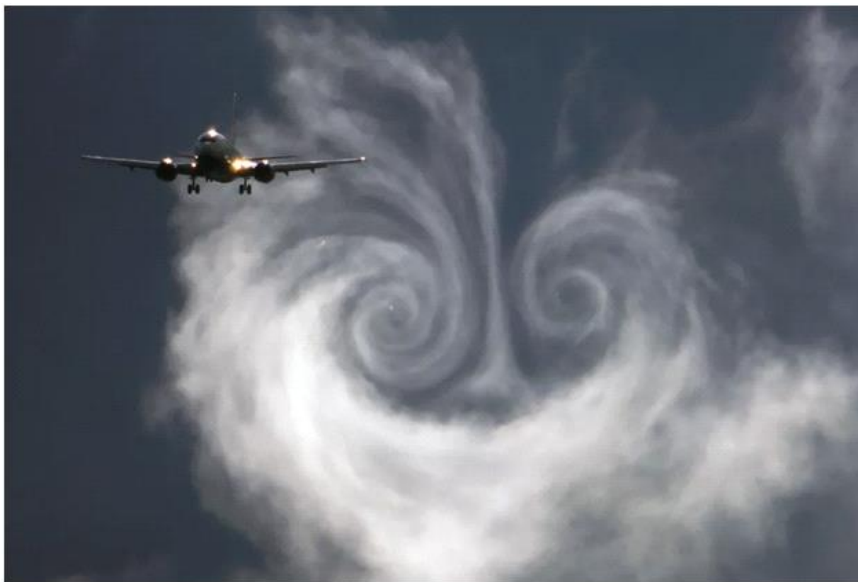
Фото.5. Вихревой след в слое тумана за летящим на высоте самолётом. Виден вертикальный поток воздуха и заходящие с боков волны воздуха, закручиваемые в спираль при соприкосновении с вертикальным нисходящим потоком.
