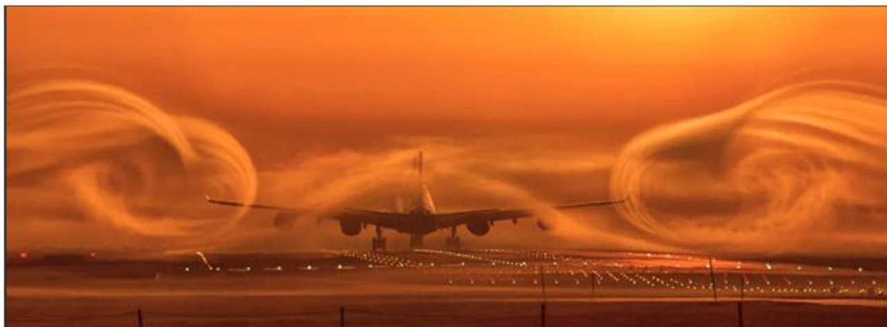
Фото.5. Вихревой след в слое тумана за летящим на высоте самолётом. Виден вертикальный поток воздуха и заходящие с боков волны воздуха, закручиваемые в спираль при соприкосновении с вертикальным нисходящим потоком.
